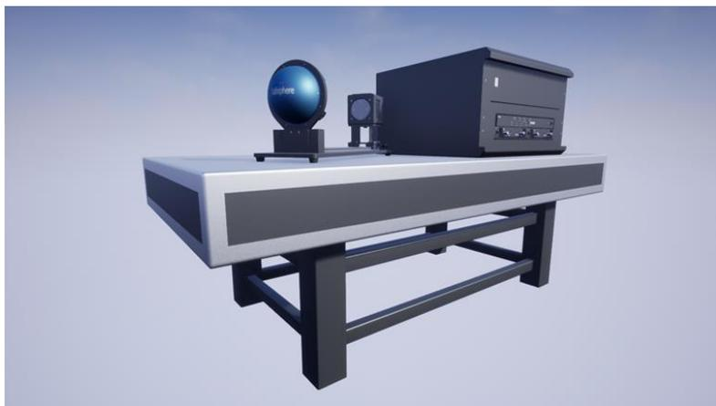
VCSEL 器件较大的发光角和快速脉冲模式使得传统的激光功率计不能得到理想的测试结果，此外，VCSEL 器件在手持式设备上的应用场景决定了功耗，电光转换效率和波长-温度漂移成为了评价 VCSEL 器件的关键指标。
